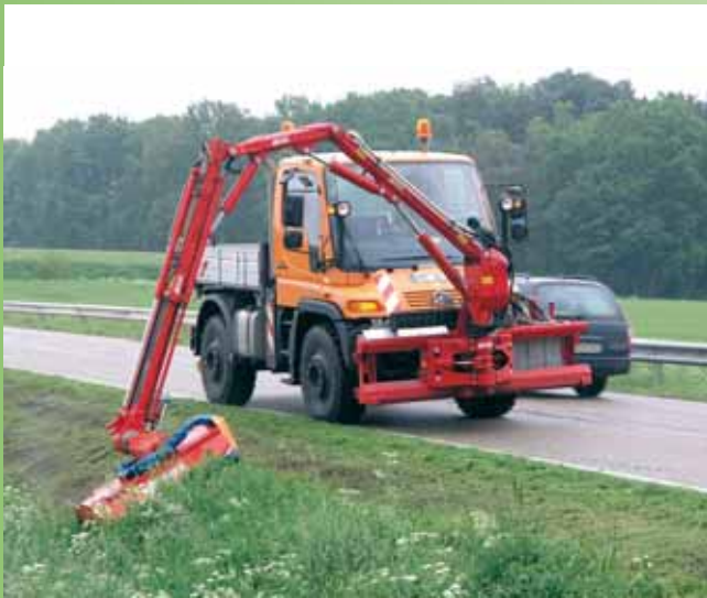
DUA 800 har 2 udliggerarme og en broarm. Rækkevidden er 7,80 m ved hjælp af en integreret teleskop i den sidste arm.
