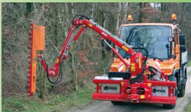
Gren- og hækkeklipperen klipper grene op til 11 cm Ø.
