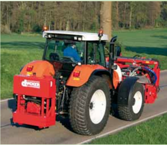
Tandemklipper MK i to delt opbygning (hydraulikaggregat er bagmonteret på Steyer traktor)
