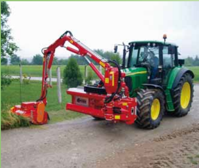
DUA 700 har 2 udliggerarme og en broarm. Rækkevidden er 6,80 m. Her ved indsats på John Deere traktor.
