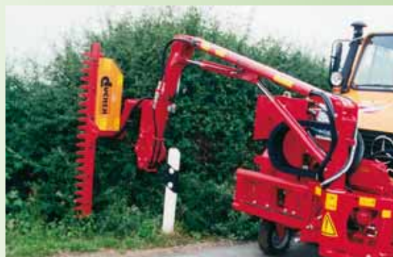
Hækkeklipperen klipper hæk som liguster, taxus, tuja eller lignende med grendiameteren op til 4,50 cm.
